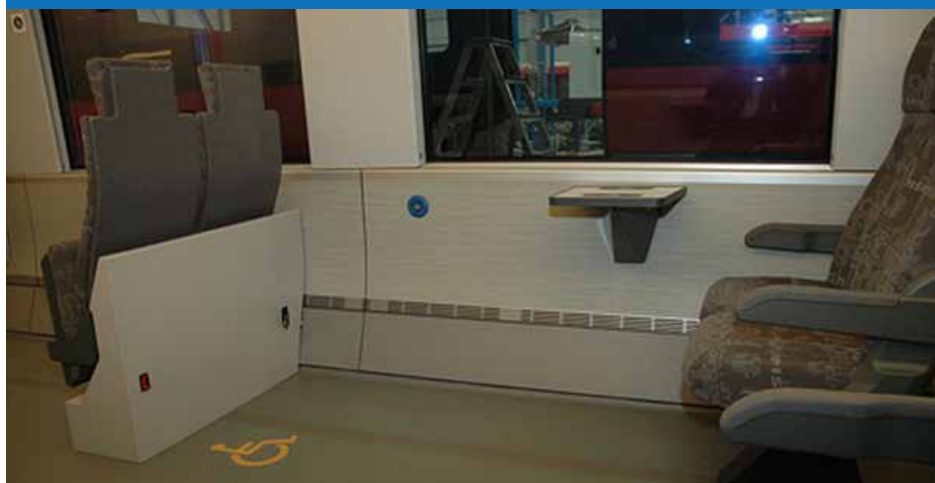
Rys. 3.16. Miejsce na wózek inwalidzki w wagonie kolei norweskich (NSB)
