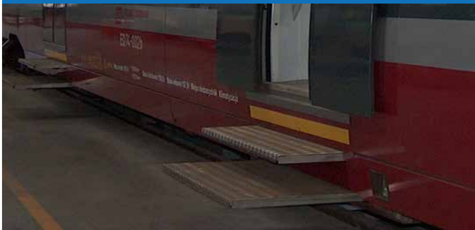
Rys. 2.55. Wysuwane stopnie w elektrycznym zespole trakcyjnym ED74, umożliwiające wejście z niskich peronów
