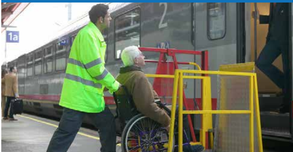
Rys. 3.8. Podnośnik peronowy stosowany na kolejach austriackich (ÖBB)
