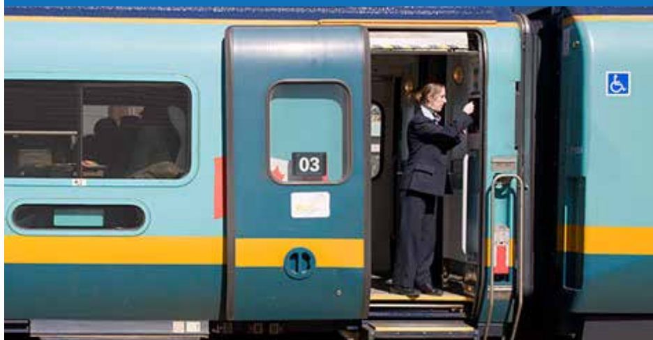
Rys. 3.24. Wysuwane stopnie wykorzystywane do niskich peronów
