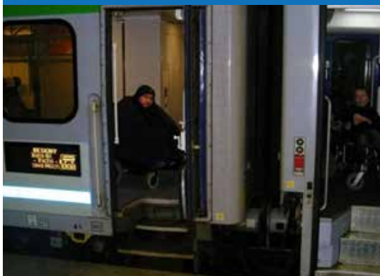
Rys. 2.45. Przykłady braku dostępności taboru przewozowego dla osób niepełnosprawnych i związane z tym utrudnienia
