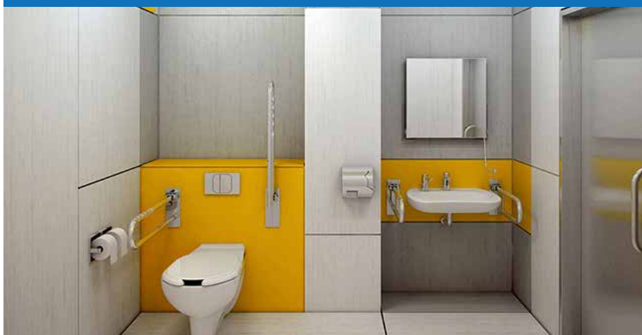
Rys. 2.15. Toaleta dostosowana do potrzeb osób poruszających się na wózkach inwalidzkich
