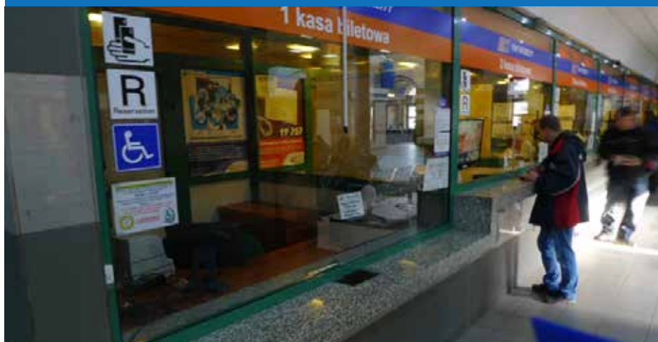
Rys. 2.18. Okienko kasowe dostosowane do obsługi osób niepełnosprawnych
