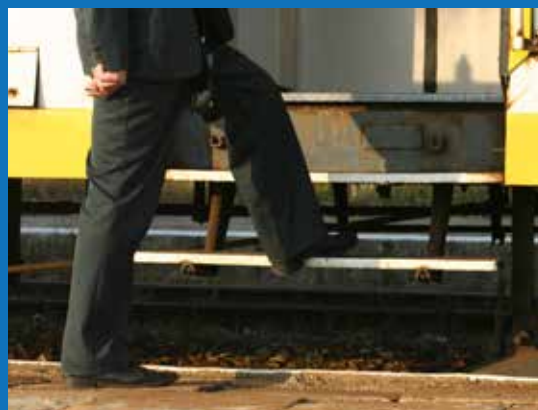
Rys. 2.46. Przykłady niedostępności wagonu dla osób niepełnosprawnych (podłoga wagonu położona znacznie wyżej niż powierzchnia peronu)
