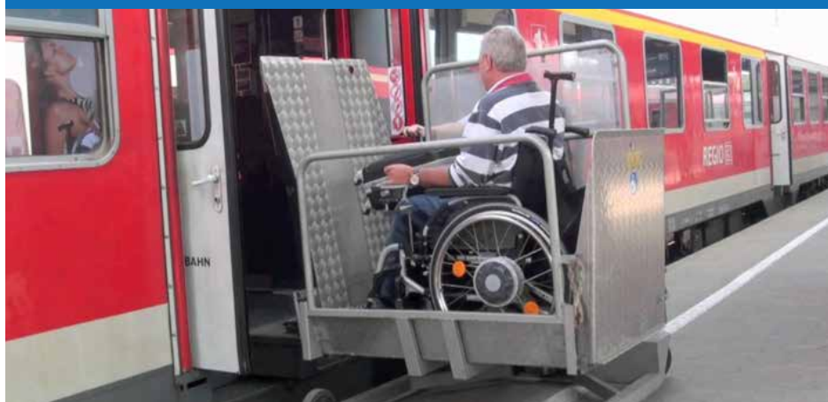
Rys. 3.3. Podnośnik peronowy wykorzystywany przez koleje niemieckie
