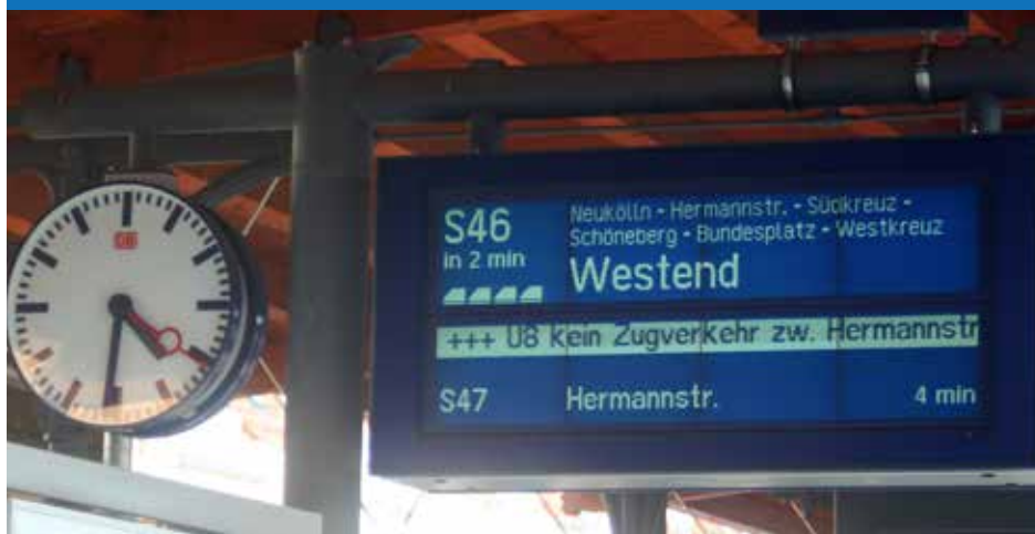
Rys. 2.65. Tablica dynamicznej informacji pasażerskiej na przystanku Köllnische Heide w Berlinie. Pasażer otrzymuje informacje nt. linii, trasy, czasu oczekiwania, a także długości składu oraz następnych kursów (fot: Adam Zajęc)
