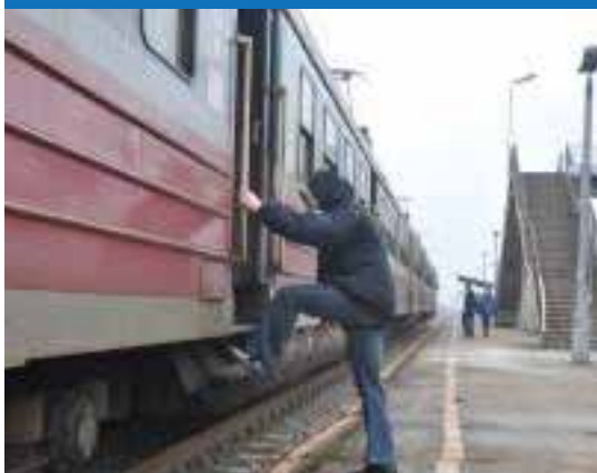
Rys. 2.46. Przykłady niedostępności wagonu dla osób niepełnosprawnych (podłoga wagonu położona znacznie wyżej niż powierzchnia peronu)
