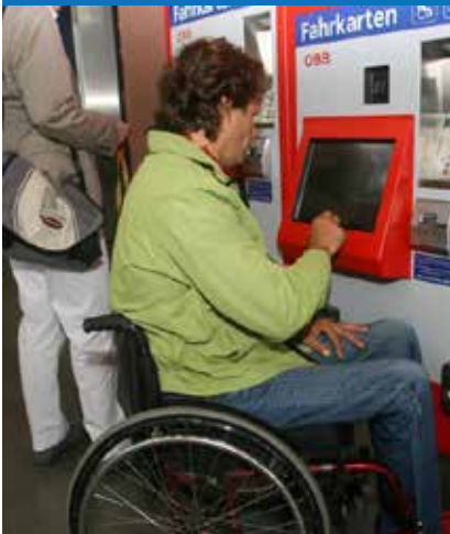
Rys. 3.9. Automat ÖBB dostosowany do potrzeb osób poruszających się na wózkach inwalidzkich
