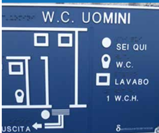
Rys. 3.20. Mapa dotykowa dla niewidomych przy drzwiach dworcowej toalety
