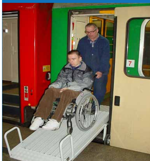
Rys. 1.4. Jeden z projektów uproszczenia wyjścia z wagonu osoby niepełnosprawnej podróżującej na wózku inwalidzkim (fot. Krzysztof Ochociński)
