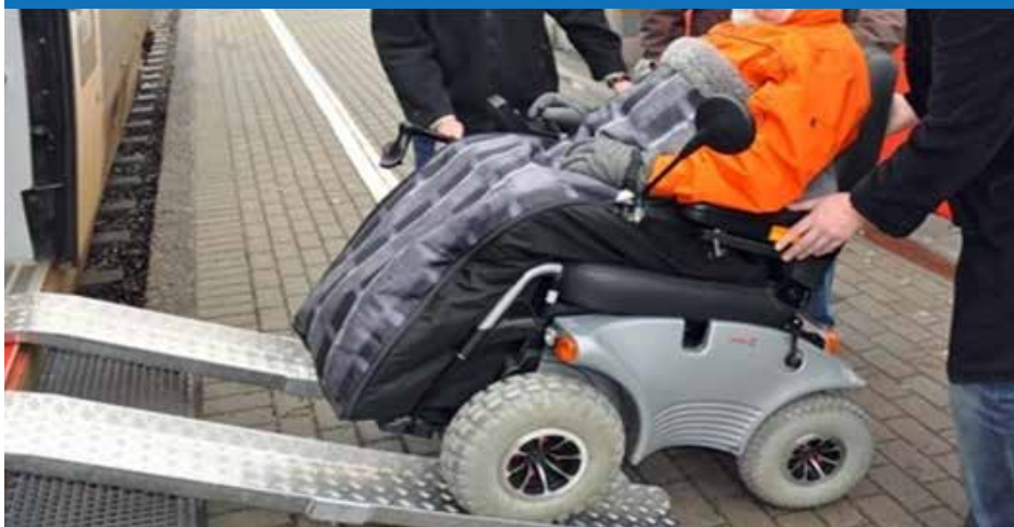
Rys. 3.4. Oryginalne rozwiązanie z dwoma prowadnicami na linii lokalnej (prowadnice są dostępne w sklepach zaopatrzenia medycznego)
